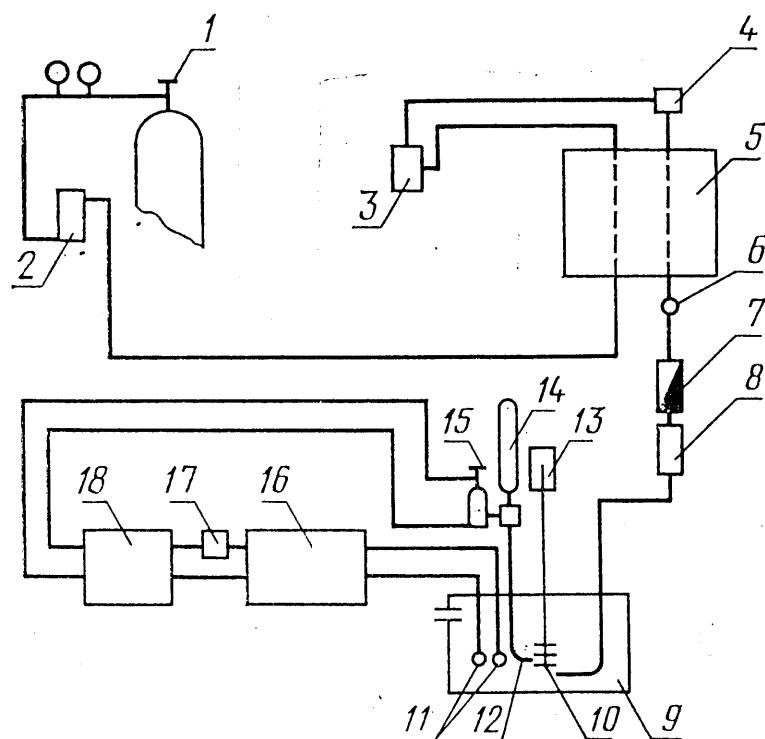
Примечание. Вместо бюретки 14, магнитного клапана 15 можно использовать автоматическую бюретку-дозатор Б-701.
